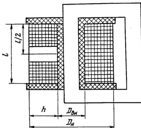
Рис. 2.2. Конструктивное исполнение катушек переменного тока
