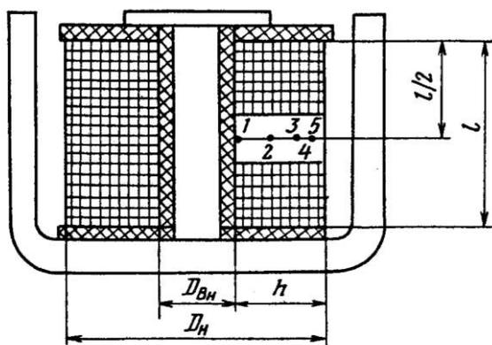
Рис. 2.1. Конструктивное исполнение катушек постоянного тока
